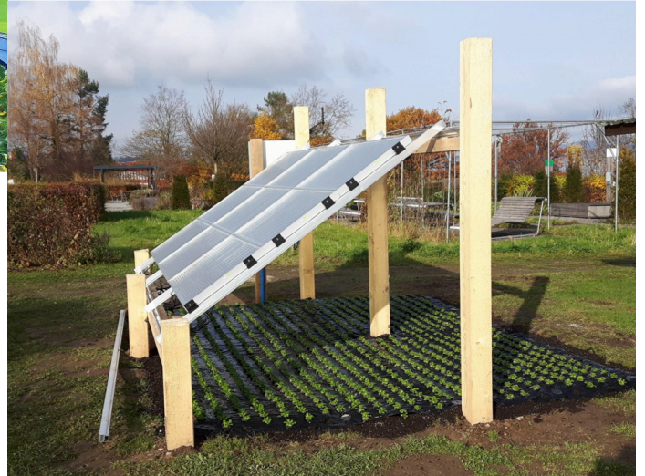
Unten: Versuchsanlage der ZHAW in Wädenswil. Unter den Photovoltaik-Modulen wächst Nüsslisalat. Foto: ZHAW
